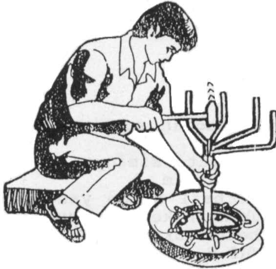
Gambar 2. Pemasangan pipa besi Z pada ban
